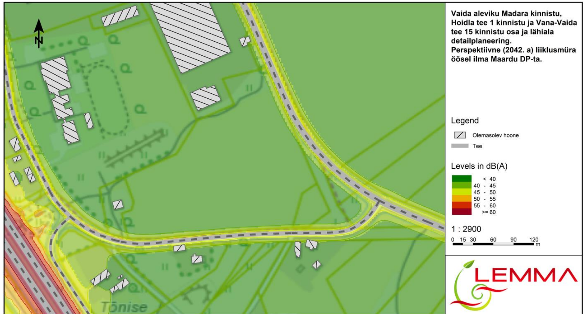
Joonis 10. Perspektiivne (2042. a) liiklusmüra ilma DP lahenduseta öösel 2 m kõrgusel maapinnast.
