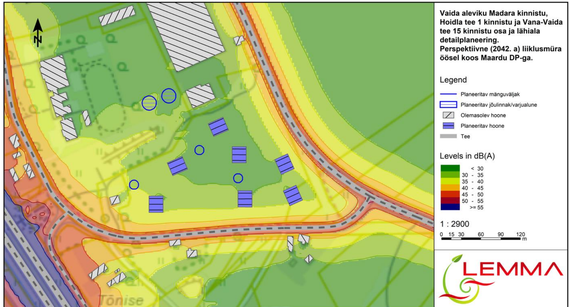
Joonis 8. Perspektiivne (2042. a) liikluse müra koos DP lahendusega öösel 2 m kõrgusel maapinnast.
