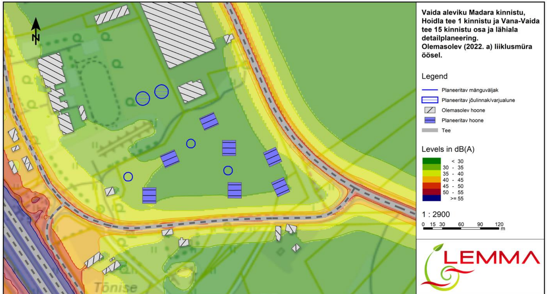
Joonis 5. Olemasolev (2022. a) liiklusrüra öösel 2 m kõrgusel maapinnast.
