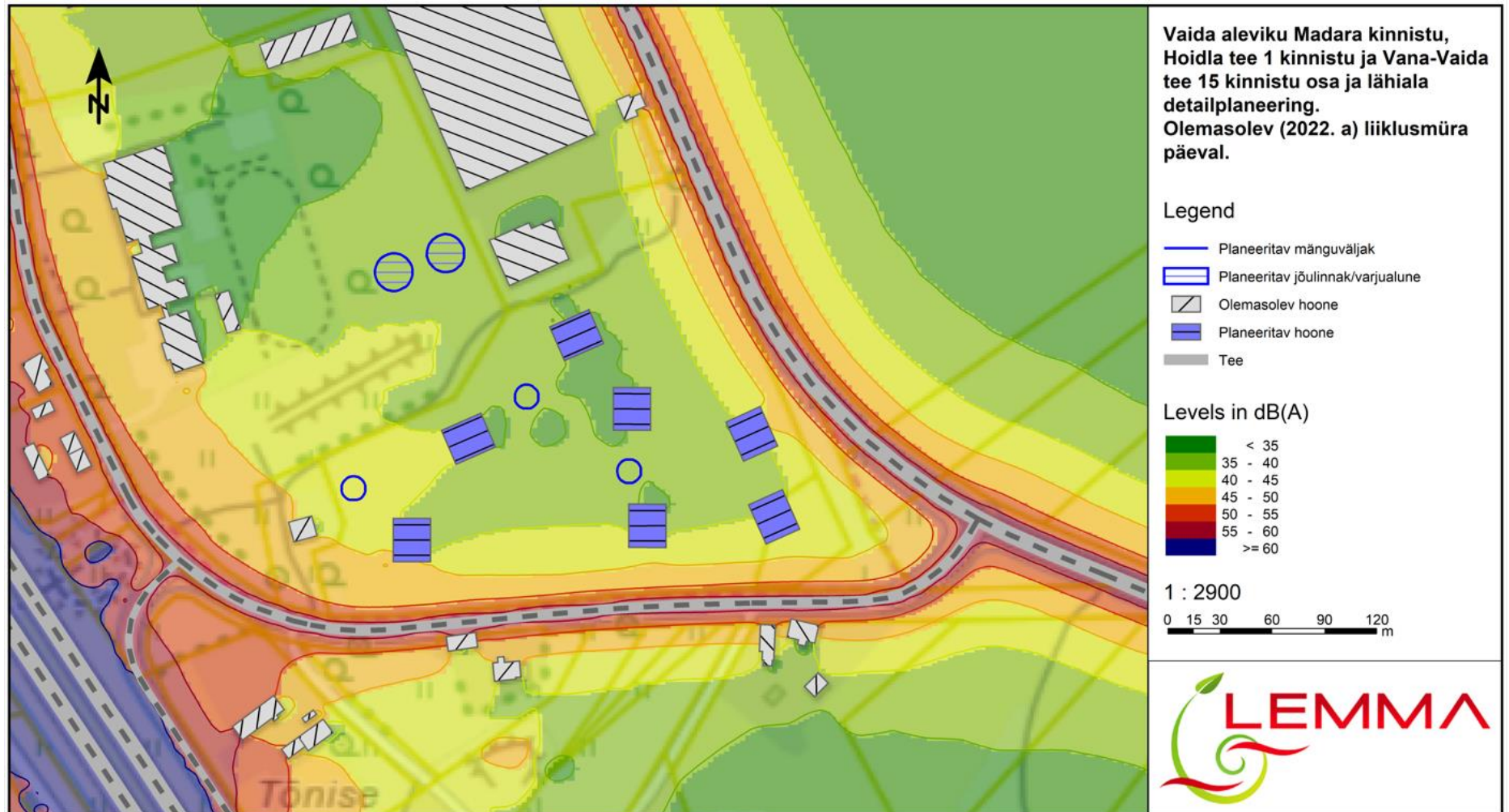
Joonis 4. Olemasolev (2022. a) liiklusrüra päeval 2 m kõrgusel maapinnast.
